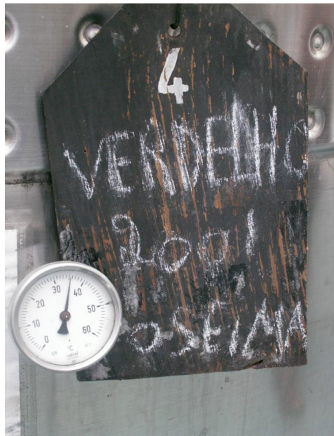
Označení vinifikátoru, jehož obsah je zahříván na teplotu 35 °C
